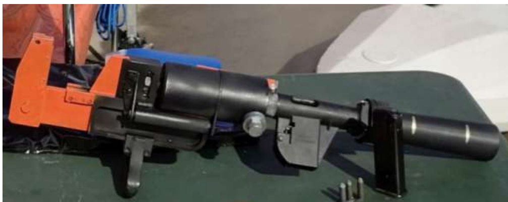
Рис. 6 – Действующий опытный макет аварийно-спасательного инструмента с пиропроводом
