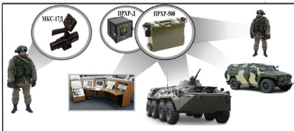
Рисунок 2. Вариант формирования системы оповещения о поступлении химических и радиоактивных веществ в окружающую среду на базе комплекса средств радиационно-химической разведки ПРХР-500, ПРХР-Д, МКС-17 Д
