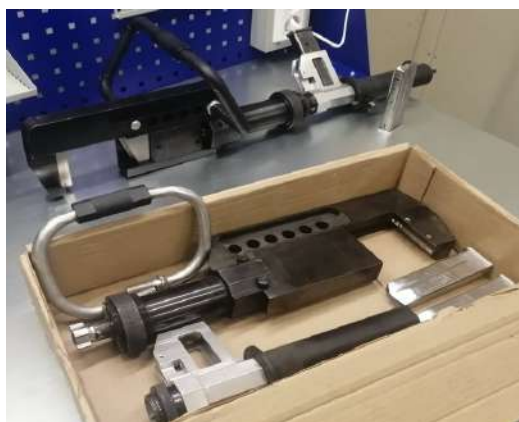
Рис. 7 – Модель опытного образца аварийно-спасательного инструмента с пиропроводом
