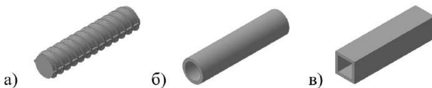
Рис. 2 - Образцы разрушаемого материала: а) арматура; б) круглая труба; в) квадратная труба
