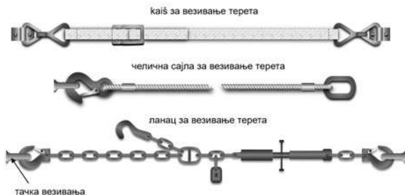
Слика 6: Илустрације сигурносних уређаја који се користе у транспорту радиоактивних материјала (Уредили аутори)
