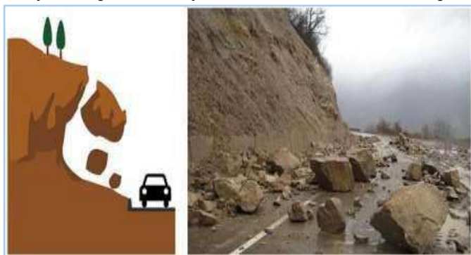
Слика 44: Шематски приказ одрона и фотографија одрона на терену 60
