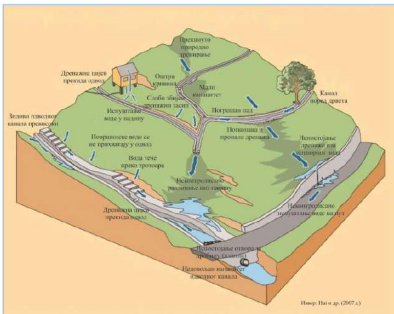
Слика 51: Лоше израђена дренажа, као фактор нестабилности падине 64
