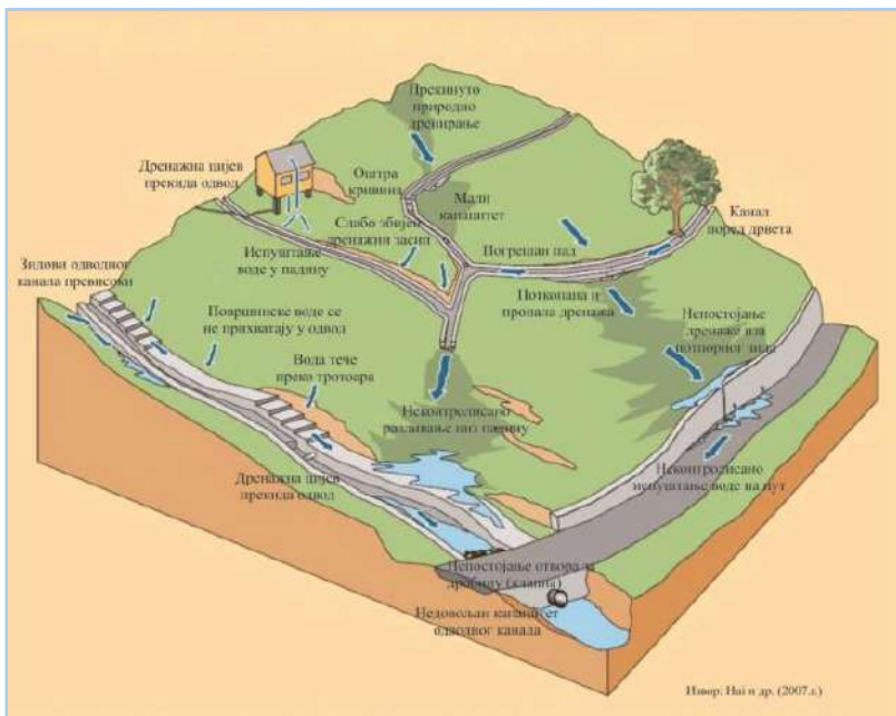
Слика 51: Лоше израђена дренажа као фактор нестабилности падине 65
