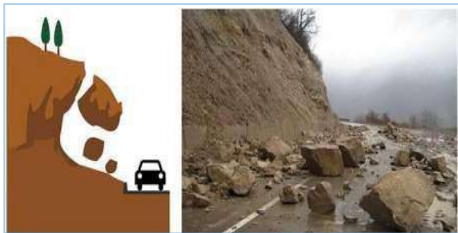
Слика 44. Шематски приказ одрона и фотографија одрона на терену 60
